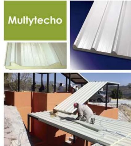
Panel fabricado compuesto por dos hojas de acero galvanizado prepintado, con un núcleo de espuma de poliuretano al centro y con una unión hermética.
